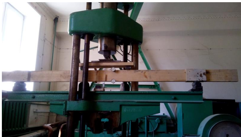
Рис. 1. Расположения индикаторов часового типа ИЧ 10 МН и прогибомера на балке Б-1
